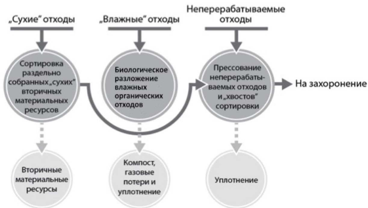
Рис. SEQ "Иллюстрация" \*Arabic 2: Параллельная схема переработки потоков отдельно собранных отходов.
